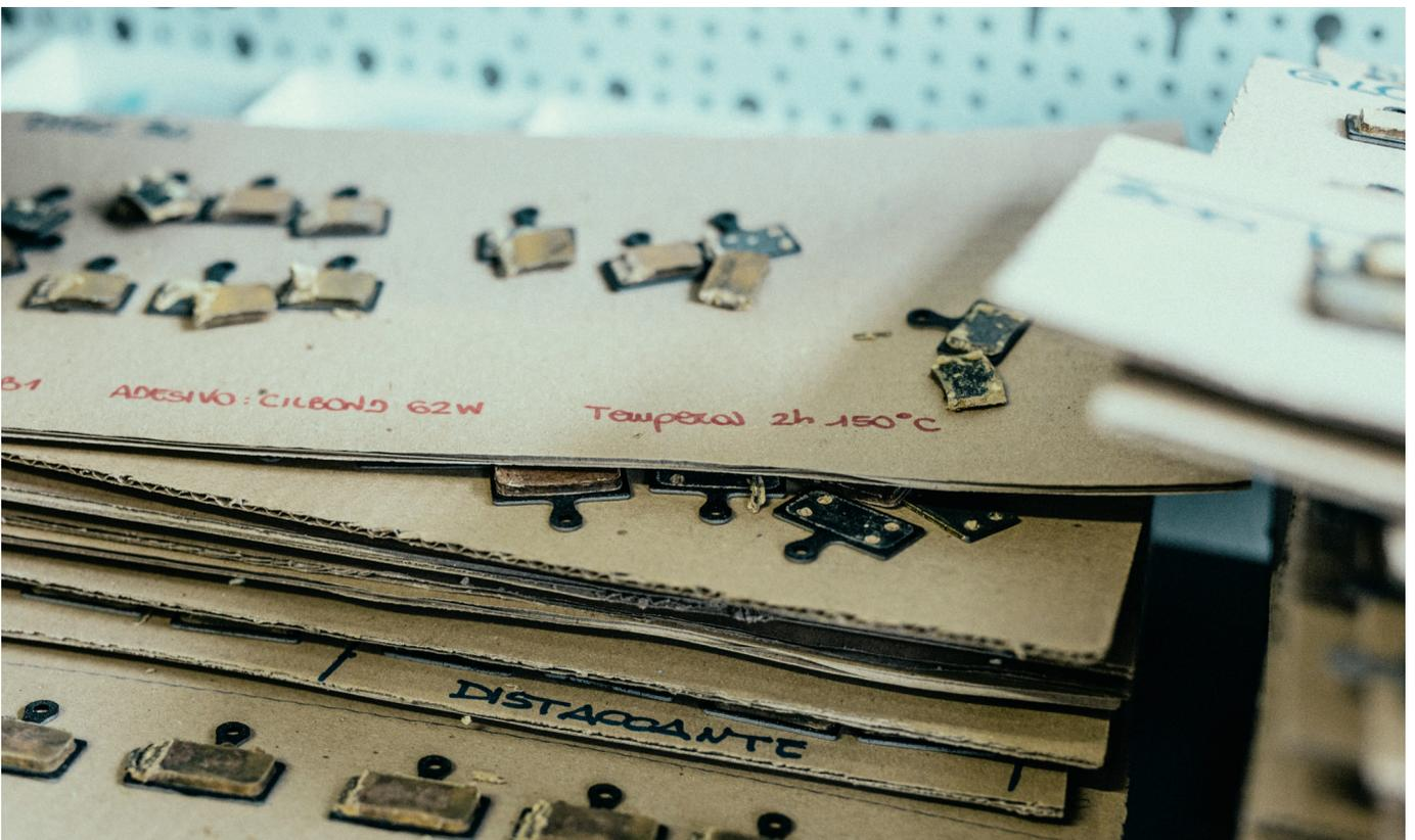
**Oben** Lackieren der Trägerplatten bevor sie im nächsten Schritt mit Kleber versehen und schließlich mit dem Belagsmaterial vereinigt werden. **Unten** Im Testlabor. Hier werden die verschiedensten Materialzusammensetzungen für Beläge analysiert und das Verhalten in Kombination mit verschiedenen Klebern abhängig von Druck, Temperatur und Zeit beim Fertigungsverfahren getestet.
