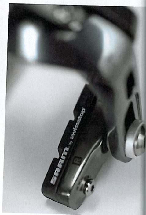
Sichere Bank: SRAM vertraut auf Beläge des Schweizer Spezialisten Swiss Stop und holt damit die meiste Leistung aus den Zangen
