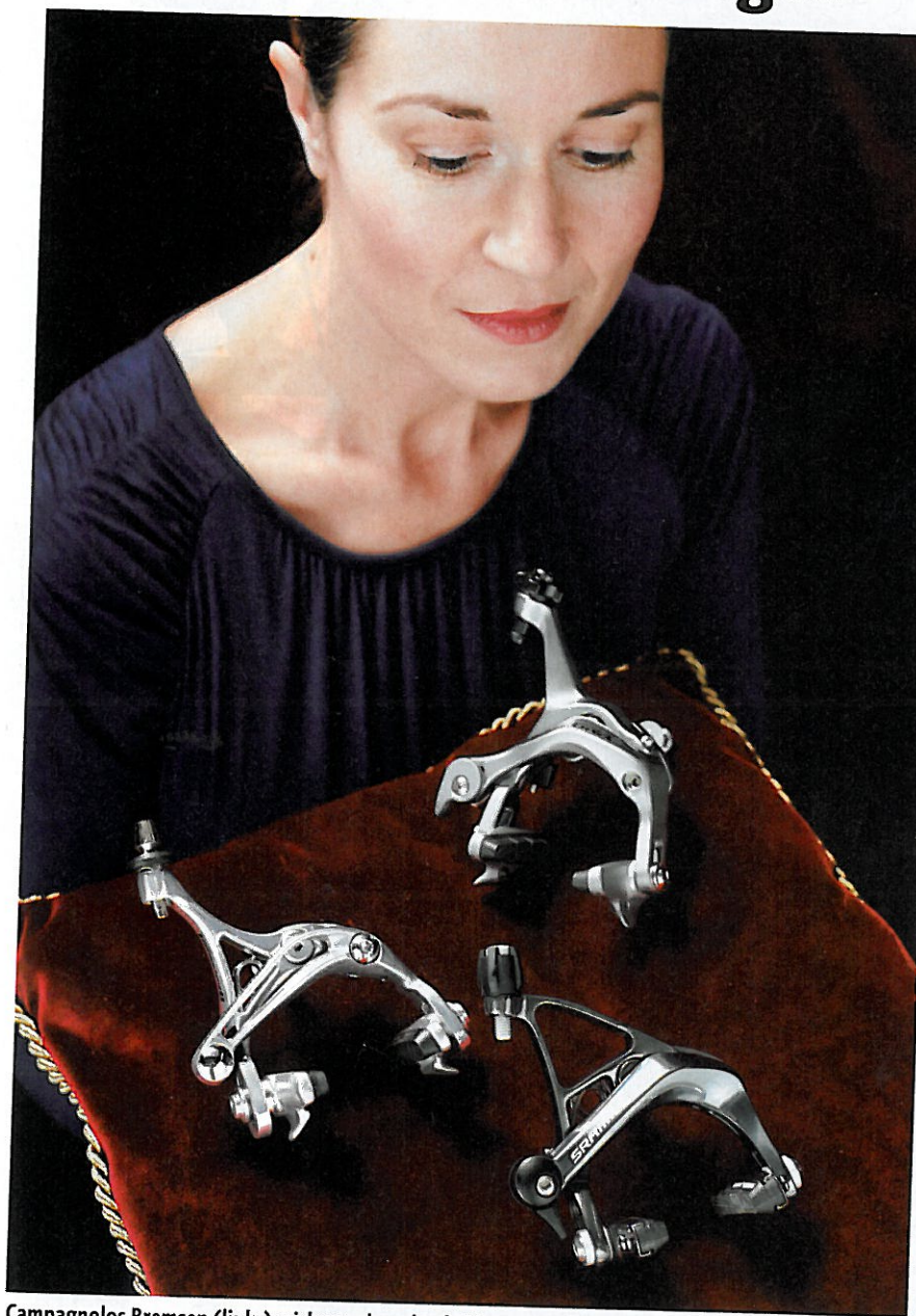
Campagnolos Bremsen (links) wirken neben den beiden grau eloxierten Konkurrenten zwar etwas weniger modern, sind aber die einzigen, die für vorn und hinten unterschiedliche Konstruktionsprinzipien aufrufen – die Vorderbremse mit zwei Gelenken packt kräftiger zu
